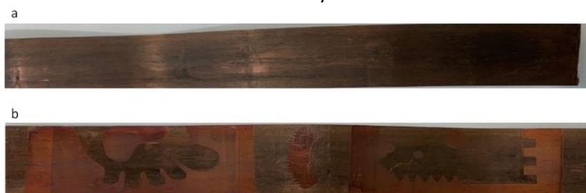
Rys. 6. Obrazy makroskopowe powierzchni stopu Cu: a) z tlenkami Cu – przed czyszczeniem laserowym; b) po czyszczeniu laserowym. Zastosowano matryce maskujące o różnych kształtach
