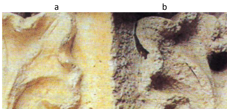
Rys. 1. Obrazy powierzchni piaskowca po czyszczeniu: a) za pomocą wiązki laserowej; b) metodą mechaniczną [6]
