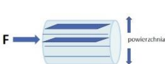
Rys. 1. Naprężenie ścinające \tau
