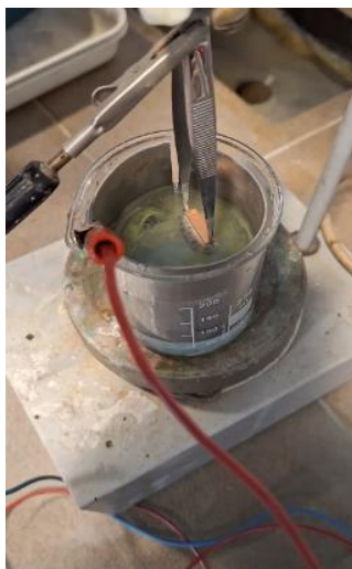
Rys. 5. Zdjęcie układu zastosowanego do wytworzenia sztucznej patyny
