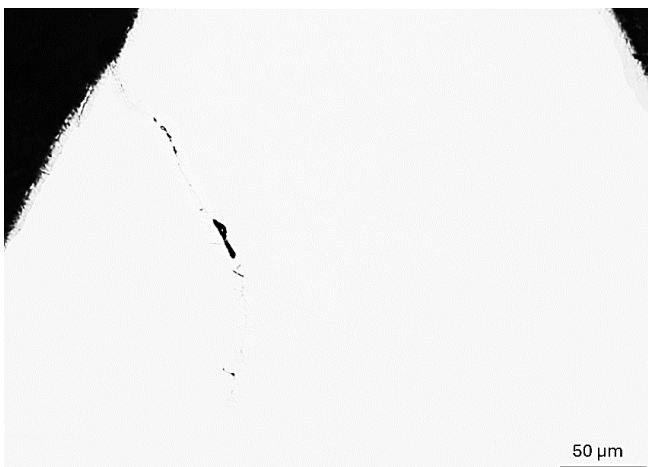
Rys. 5. Rozwój pęknięcia na próbce 5 (stal ferrytyczna), zgład nietrawiony, pow. obiektywu 50x
