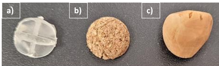
Rys. 3. Kształt kulek stosowanych w gwizdkach, a) kulka polimerowa, b i c) kulka wykonana z korka
